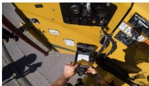
**Antes de realizar cualquier tipo de mantenimiento, asegúrese de que la trituradora esté apagada**, que se retire la llave de encendido y que el disco o el tambor de astillas estén asegurados en su lugar.
